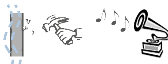
Trasmissione per via strutturale
