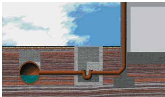
Esempio di installazione di sifoni AN in un pozzetto di cemento esternamente all'abitazione e prima del collegamento al collettore principale.
