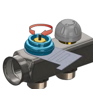
3 – Avvitare la ghiera sul collettore
