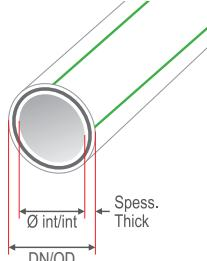
**TUBO FASER FIBER-LIGHT**, tubo pluristrato con strato intermedio caricato con fibre speciali
