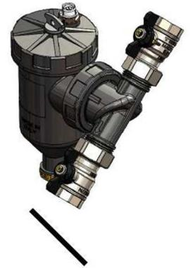
1. TM MAG PLUS va installato preferibilmente sulla tubazione di ritorno dal generatore. In caso di acque molto sporche, si consiglia di utilizzare il filtro a maglia fine da 500  $\mu\text{m}$  per effettuare il lavaggio dell'impianto. Al termine del lavaggio, la cartuccia a maglia fine va sostituita con la cartuccia standard da 800  $\mu\text{m}$ . Il defangatore va installato preferibilmente a monte del circolatore per evitare che la pompa spinga direttamente verso il defangatore.
