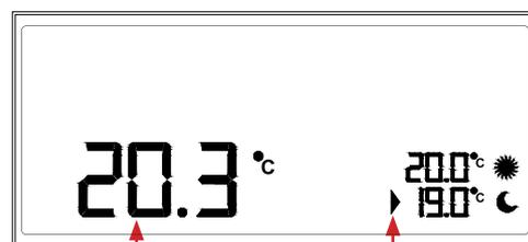
Questo è il valore della temperatura ambiente rilevata dal sensore interno / sonda remota.
